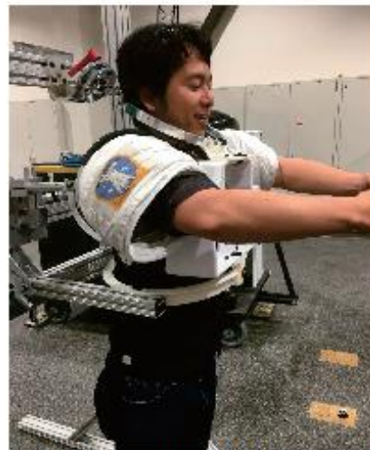
宇宙服着用時の上肢の動作範囲を解析するための実験装置（理工学部・伊藤彰人准教授が装着した様子）
